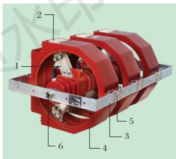
1 动触头 2 隔离开关静触头 3 安装支架 4 绝缘支架 5 接地静触头 6 操作轴
